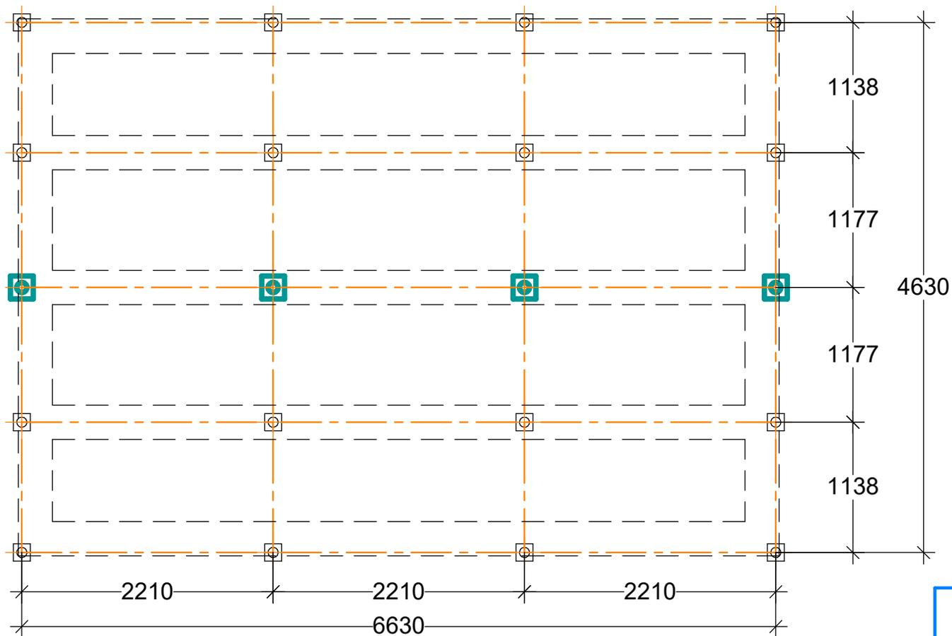
— — — бетонный ленточный фундамент
